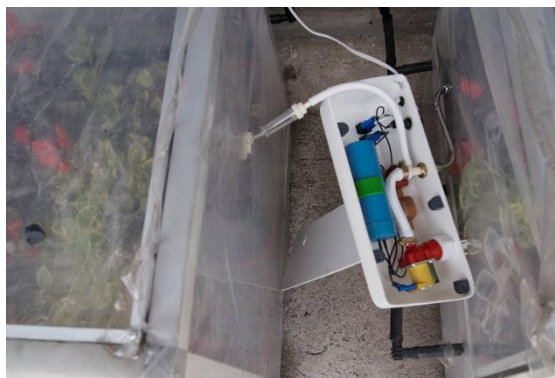
Figura 14. Inyección del ozono a las celdas de experimentación.
