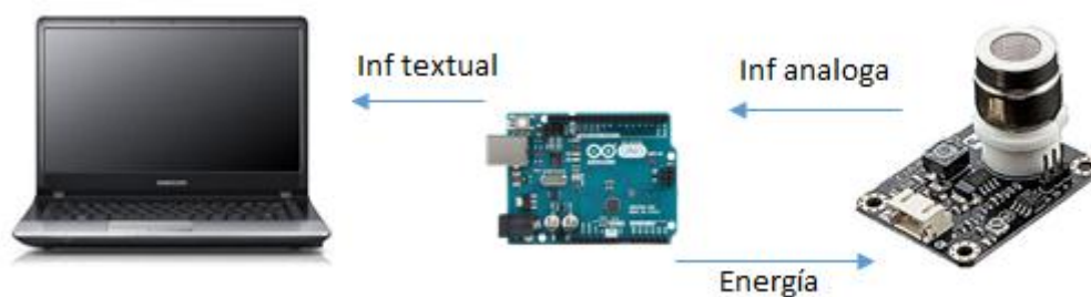
Figura 15. Sistema y transferencia del sensor de CO 2
