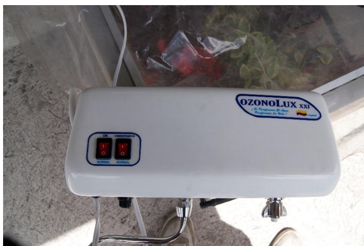
Figura 13.- Generador de ozono adaptado marca OZONOLUX.
