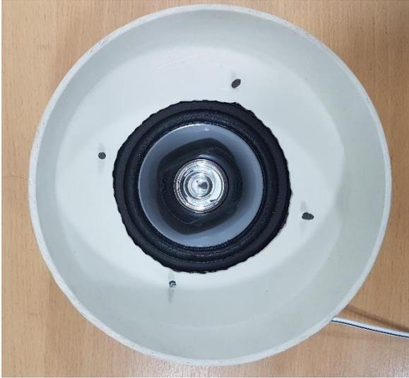
Figura 14. Vista frontal de acople entre altavoz y tapa de PVC.
