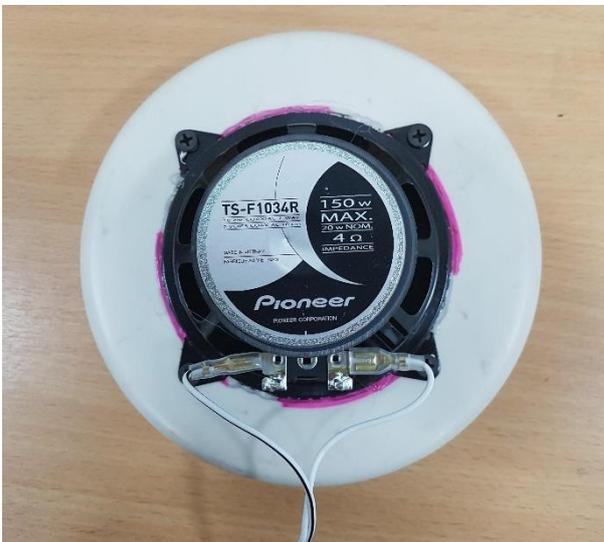
Figura 15. Vista posterior de acople entre altavoz y tapa de PVC.
