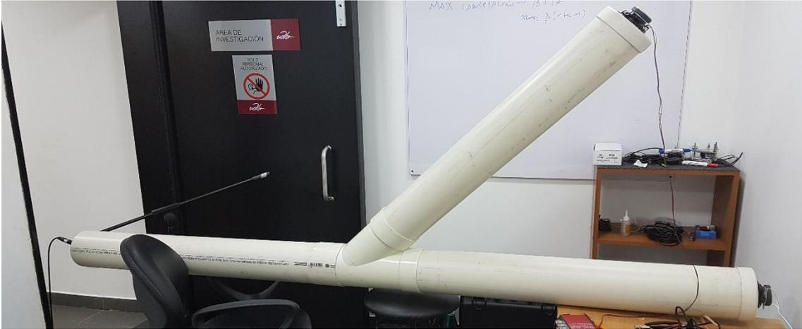
*Figura 16.* Sistema de control con acople de ductos y altavoces.
