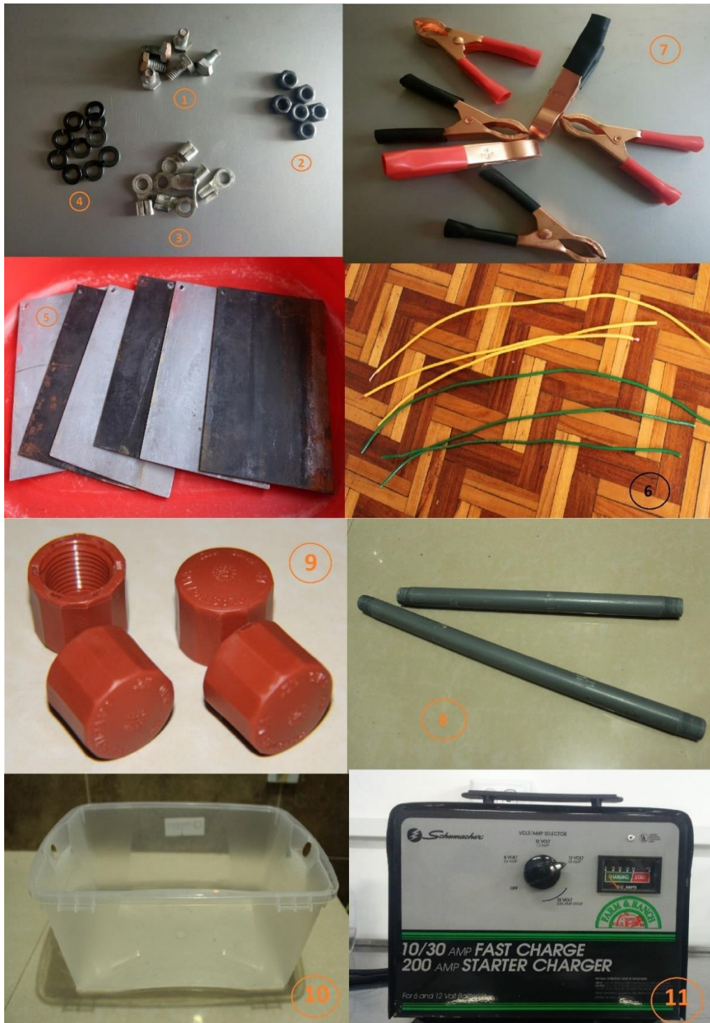
Figura 40. Materiales para electrocoagulación; 1) Tornillos Hexagonales, 2) Tuercas, 3) Terminales eléctricos, 4) Arandelas de presión, 5) Placas de hierro y aluminio, 6) Cable No. 8, 7) Pinzas Tipo Lagartos, 8) Tubo PVC, 9) Tapones de PVC 10) Recipiente de plástico, 11) Cargador de Batería.
