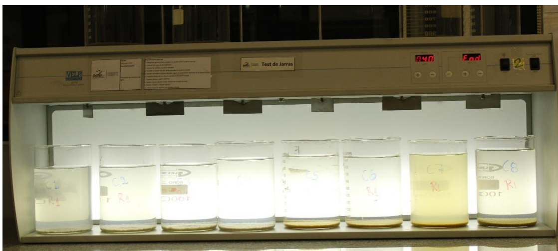
Figura 10. Test de Jarras de marca VELP SCIENTIFICA modelo JLT6 Flocculation Tester.
