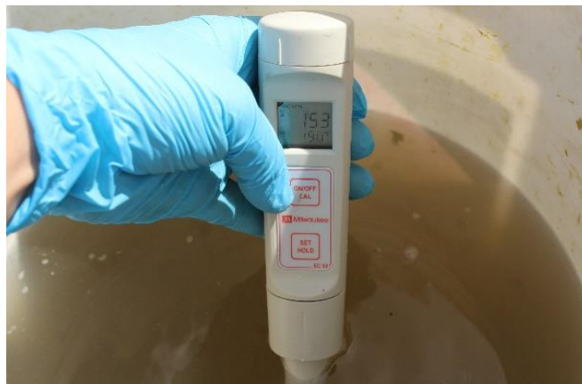
Figura 6. Medición de Conductividad en el Sitio de muestreo con el equipo Milwaukee Ec 59.
