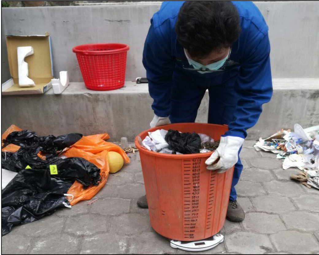
Anexo N°16. Determinación de la composición física de los RS.
