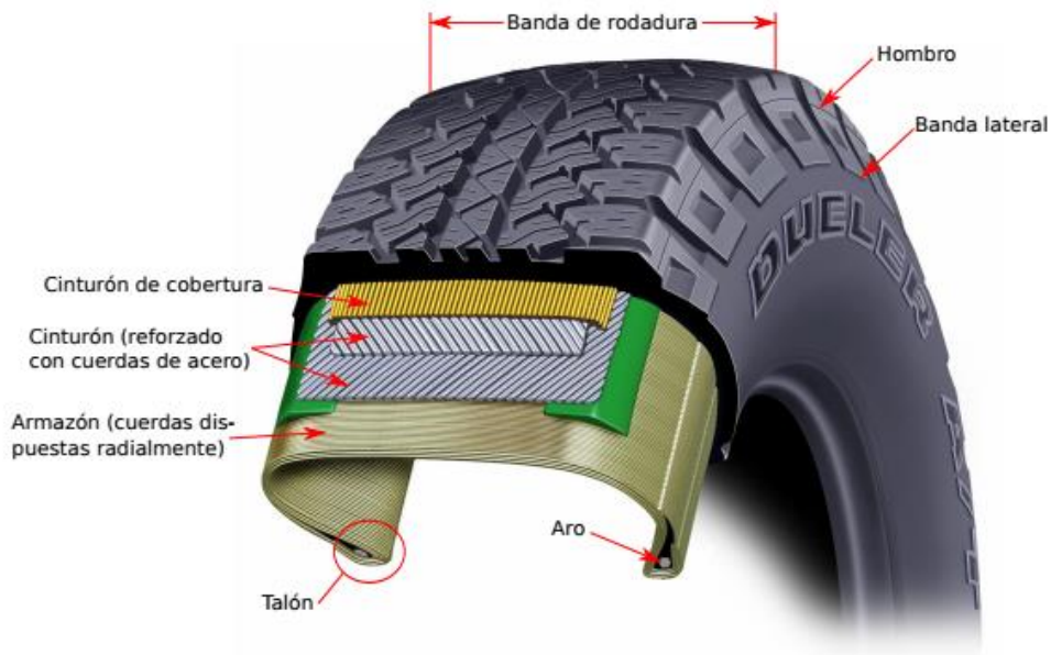
Figura 4. Partes de un neumático típico.
