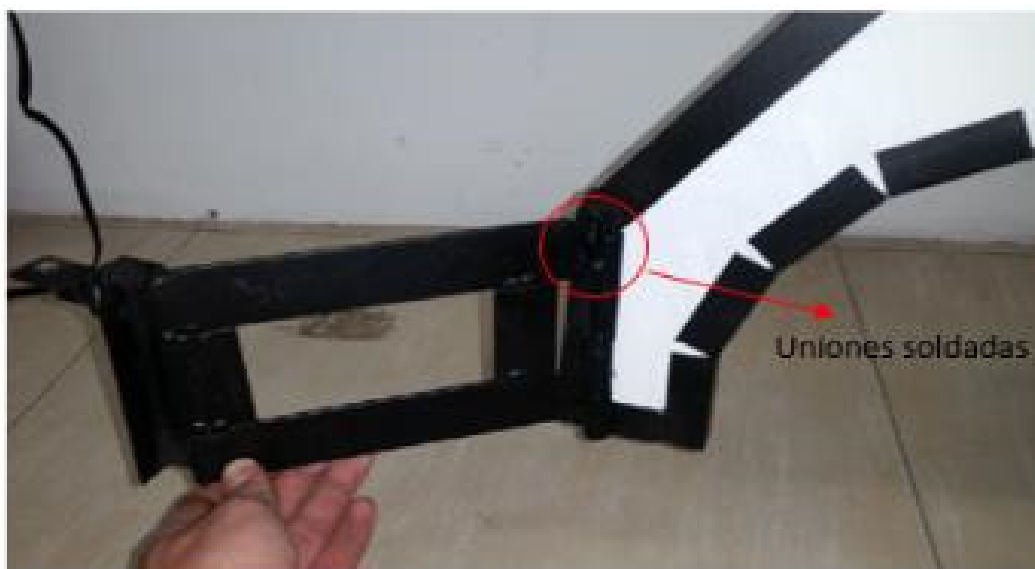
Figura 10. Ensamble de dos piezas de metal soldadas a una bisagra.
