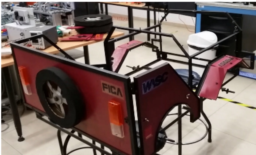
Figura 51. Montaje Nro.1 de los paneles de madera.
