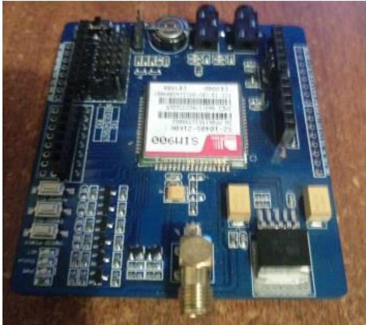
Figura 44. Fotografía de shield Sim 900 utilizada en el diseño.
