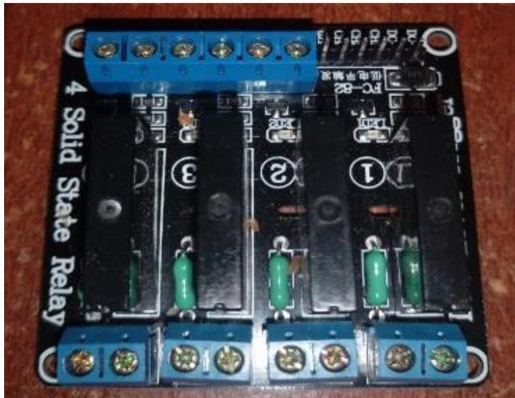
Figura 43. Fotografía del módulo de relés de estado sólido utilizado
