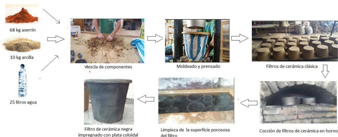
**Figura 34.** Producción de filtros de agua de cerámica negra en la fábrica “Horeb” Pifo-Ecuador
