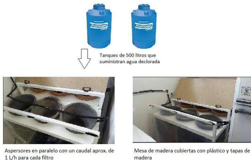
**Figura 36.** Montaje sistema continuo de filtración
