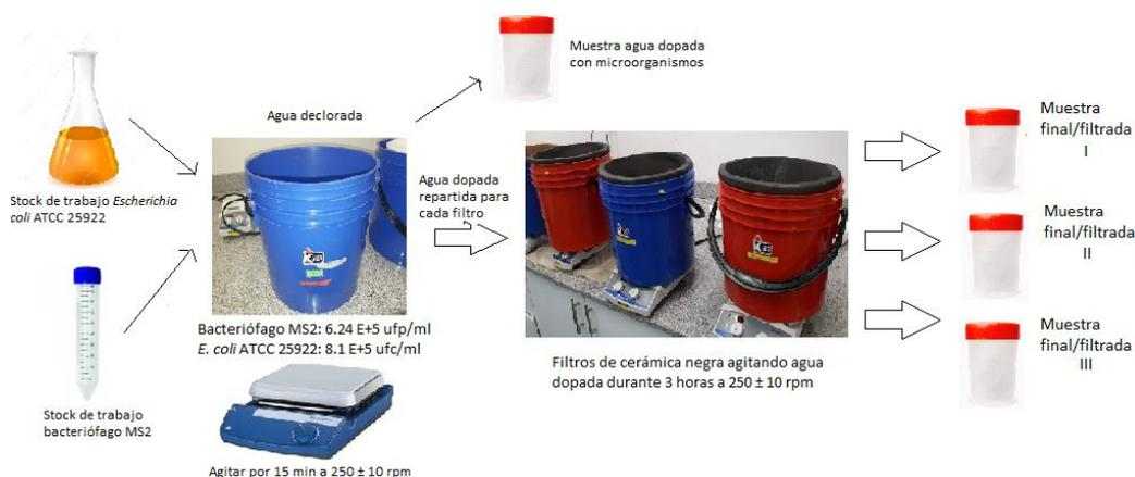
**Figura 35.** Test de eficacia microbiológica a nivel de laboratorio de los filtros elaborados
