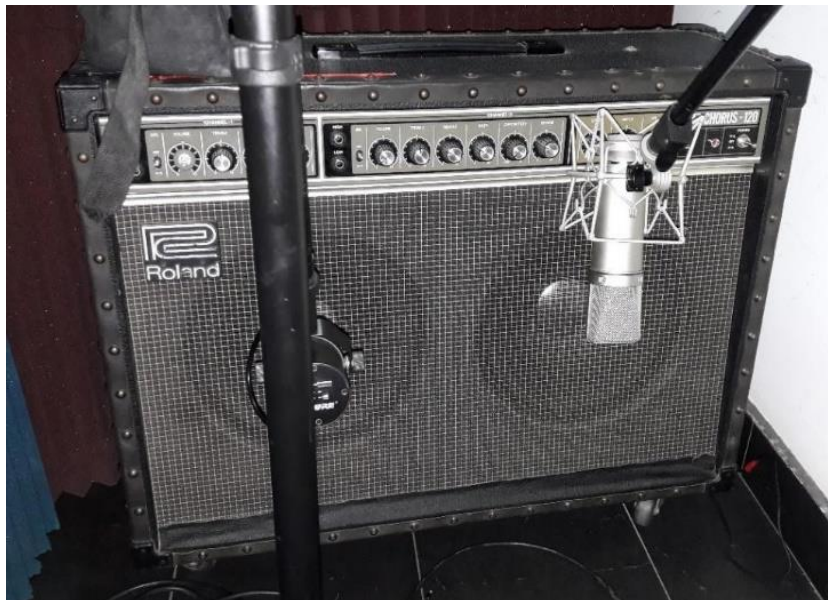
Figura 13. Técnica de microfónica para amplificador con Neumann U87 Vintage y Shure Sm7
