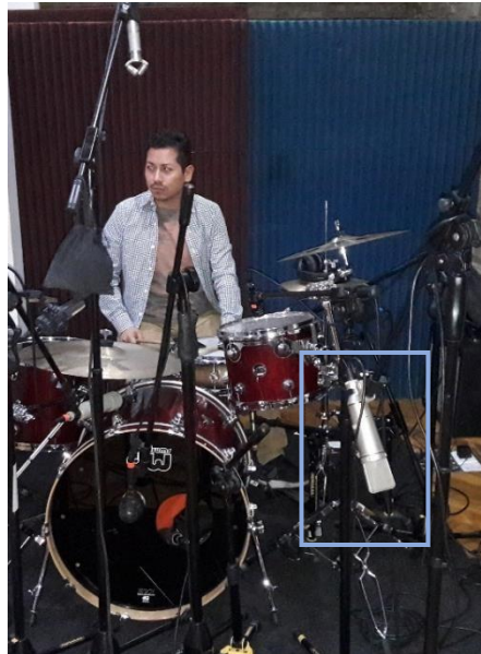
Figura 10. Técnica de microfónica para con Neumann U87 Vintage.
