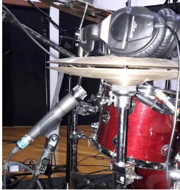
Figura 6. Técnica de microfonía para Hi-hat con Shure SM57.
