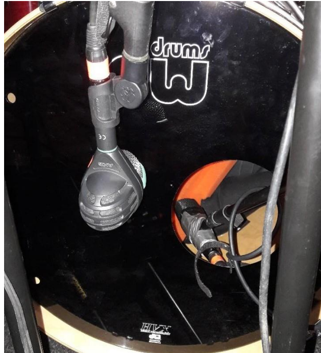
Figura 2. Técnica de microfónica para bombo con AKG D112 MKII y Sennheiser MD 421 II
