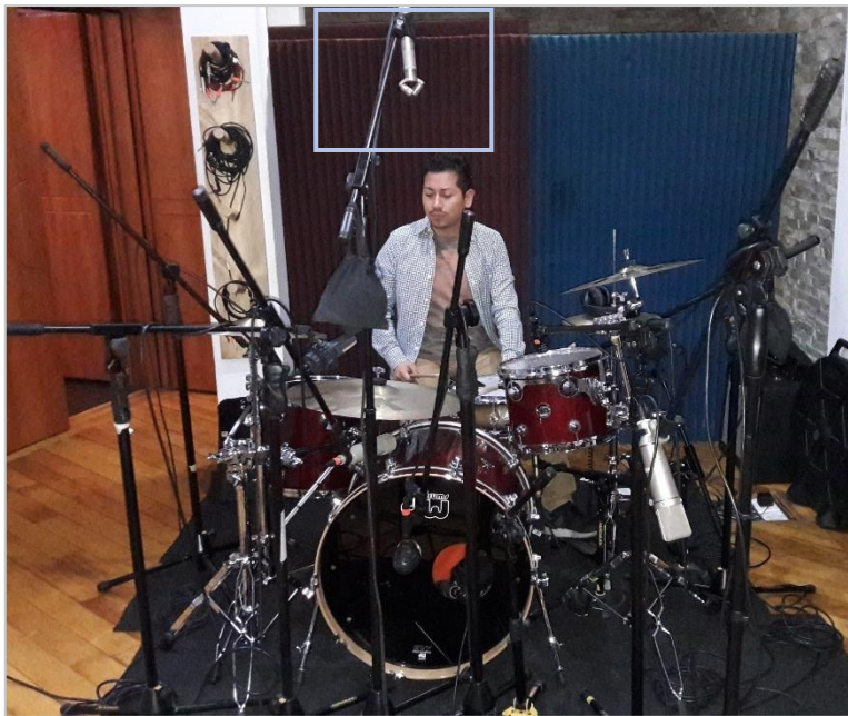
Figura 7. Técnica de microfonía para overheads con Rode NT4.
