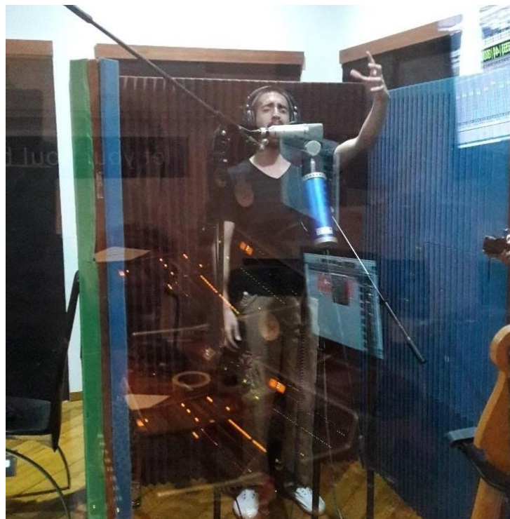
Figura 14. Técnica de microfonía para voz con Blue Bottle Tuve Condenser Microphone y Neumann U87 Vintage
