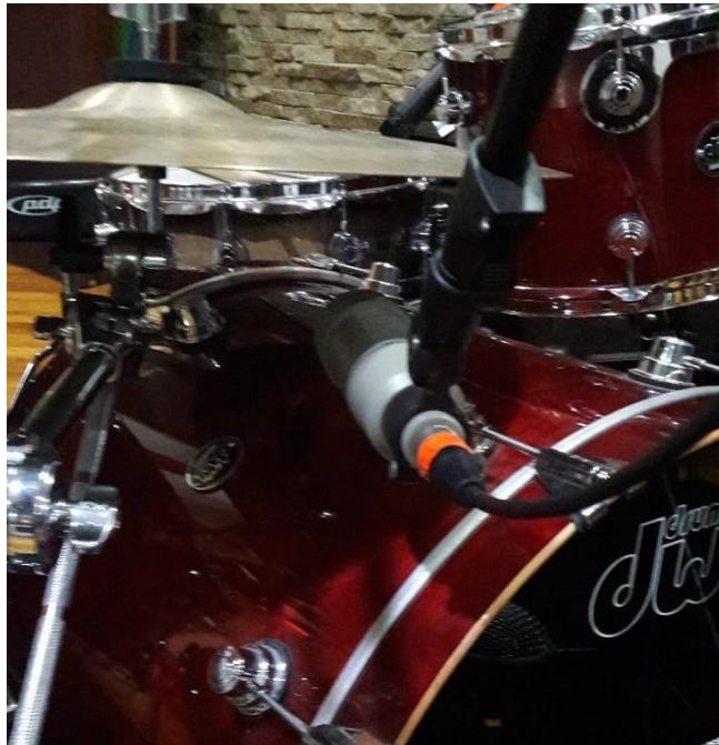
Figura 9. Técnica de microfónica para ride con Electro Voice RE20.
