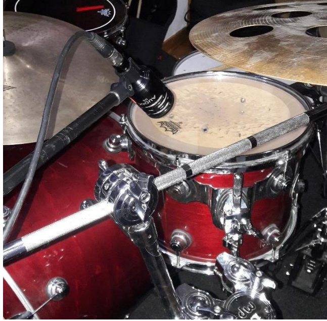
Figura 5. Técnica de microfónica para Tom con AudixD6.
