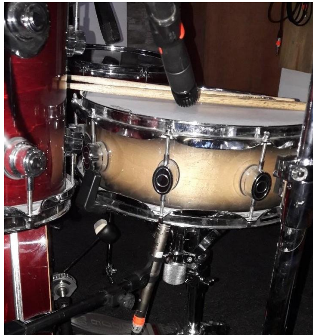
Figura 3. Técnica de microfonía para caja con AKG 451 B y Shure SM57
