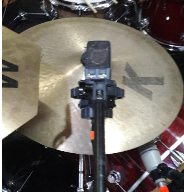
Figura 8. Técnica de microfónica para ride con AKG C 414 XLII.
