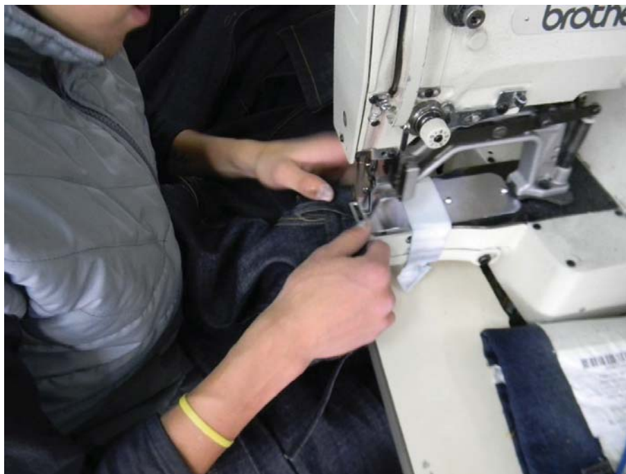
Figura 32. El operario está atracando pasadores, tarea que conforma el proceso de ensamble.
