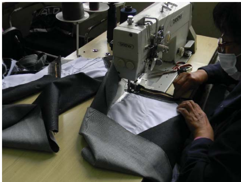
Figura 30. La operaria está uniendo el delantero, tarea que conforma el proceso de confección del delantero.
