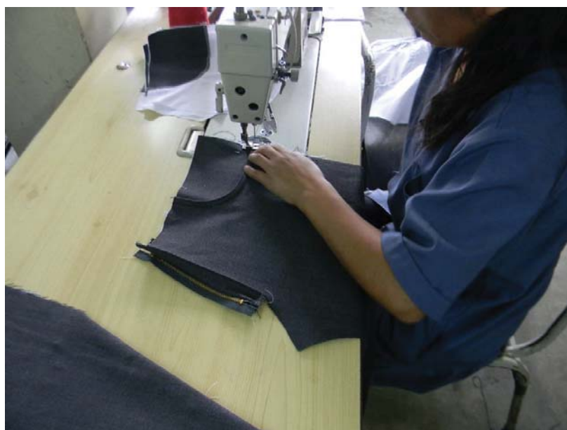
Figura 29. La operaria realiza la estabilización del falso en la boca de bolsillo en vista, tarea que conforma el proceso de preparación del delantero.
