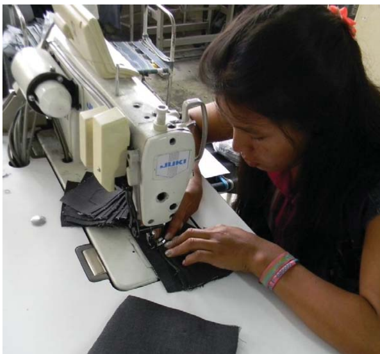
Figura 28. La operaria filetea el aletillón, tarea que conforma el proceso de fabricación del aletillón.
