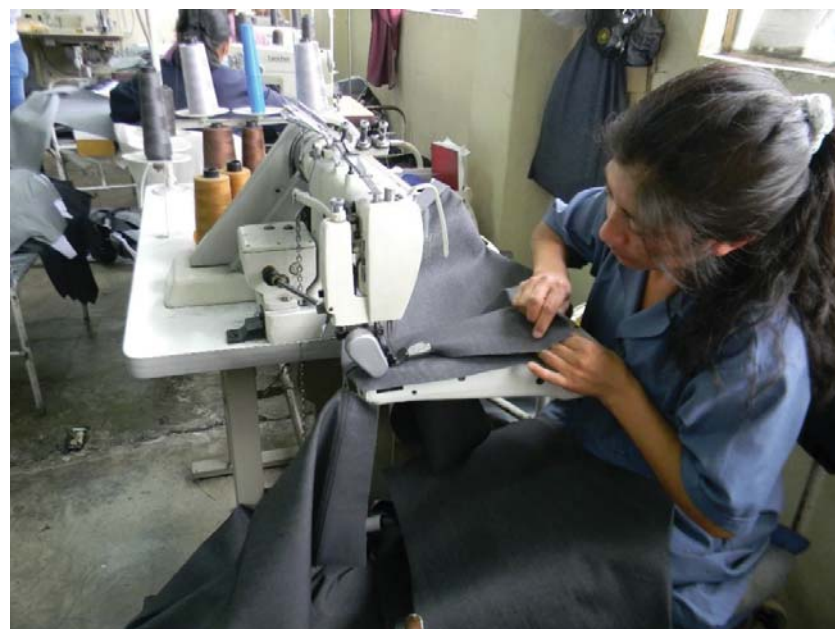
Figura 31. La operaria está cerrando el tiro trasero del pantalón, tarea que conforma el proceso de confección posterior.
