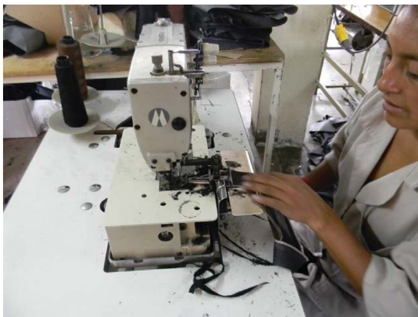
Figura 26. La operaria introduce la pieza para elaborar el pasador, tarea que conforma el proceso de fabricación de pasadores.
