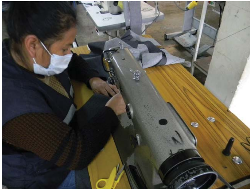
Figura 25. La operaria realiza la unión de la pieza pretina, tarea que conforma el proceso de fabricación de la pretina.
