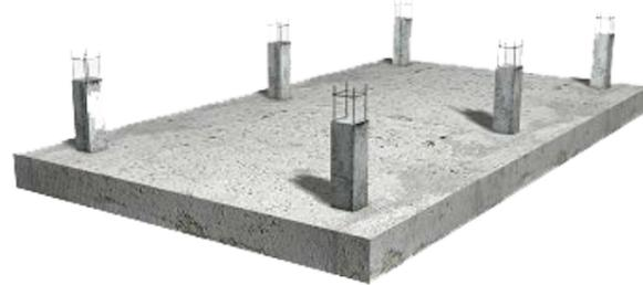
Figura 117. Losa de Cimentación Tomado de maquinariacimentaciones, s.f.
