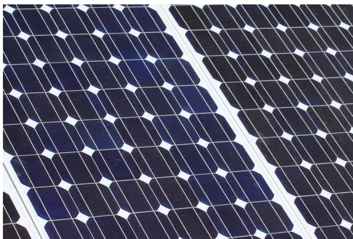
Figura 21. Panel Solar Fotovoltaico Monocristalino Tomado de (Empresa Eficiente, 2016)
