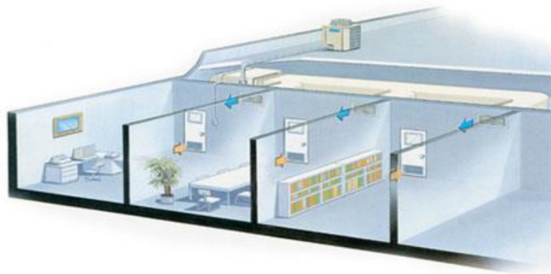
Figura 39. Aire acondicionado central Adaptado de (Aire Acondicionado, 2012)
