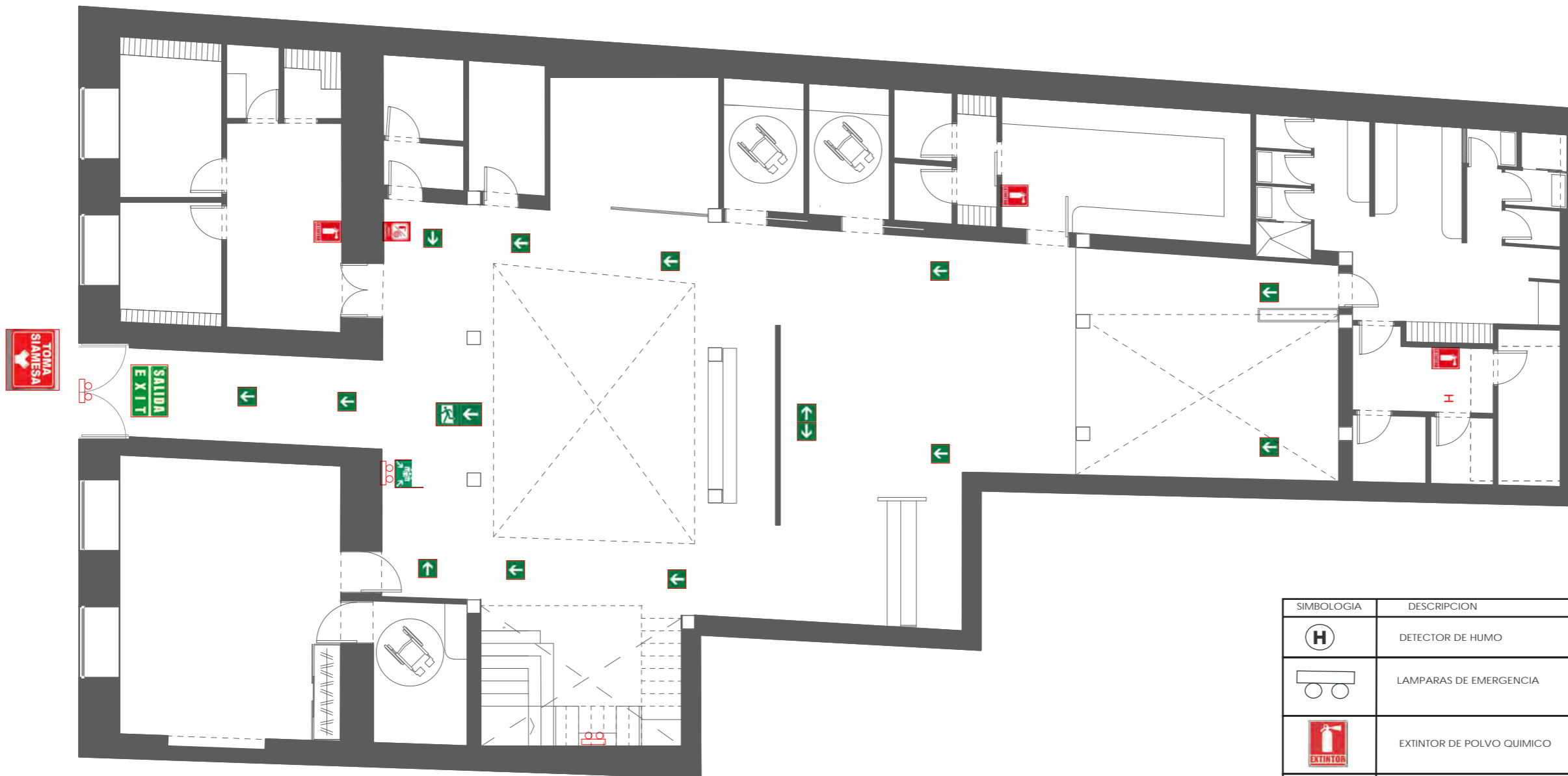
PLANO DE PREVENCIÓN CONTRA INCENDIOS PLANTA BAJA
