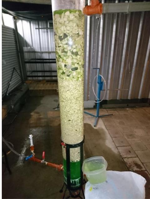
Ensayo de tiempo de residencia con el uso del trazador y con un medio de piedra caliza de 15-20mm.
