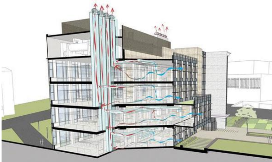
Figura 44. Sistema de ventilación natural por diferente temperatura
