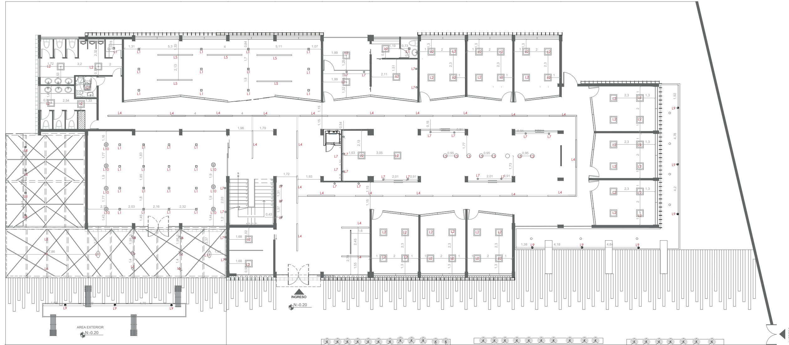
PLANTA DE LUMINARIAS ESC:1:200
