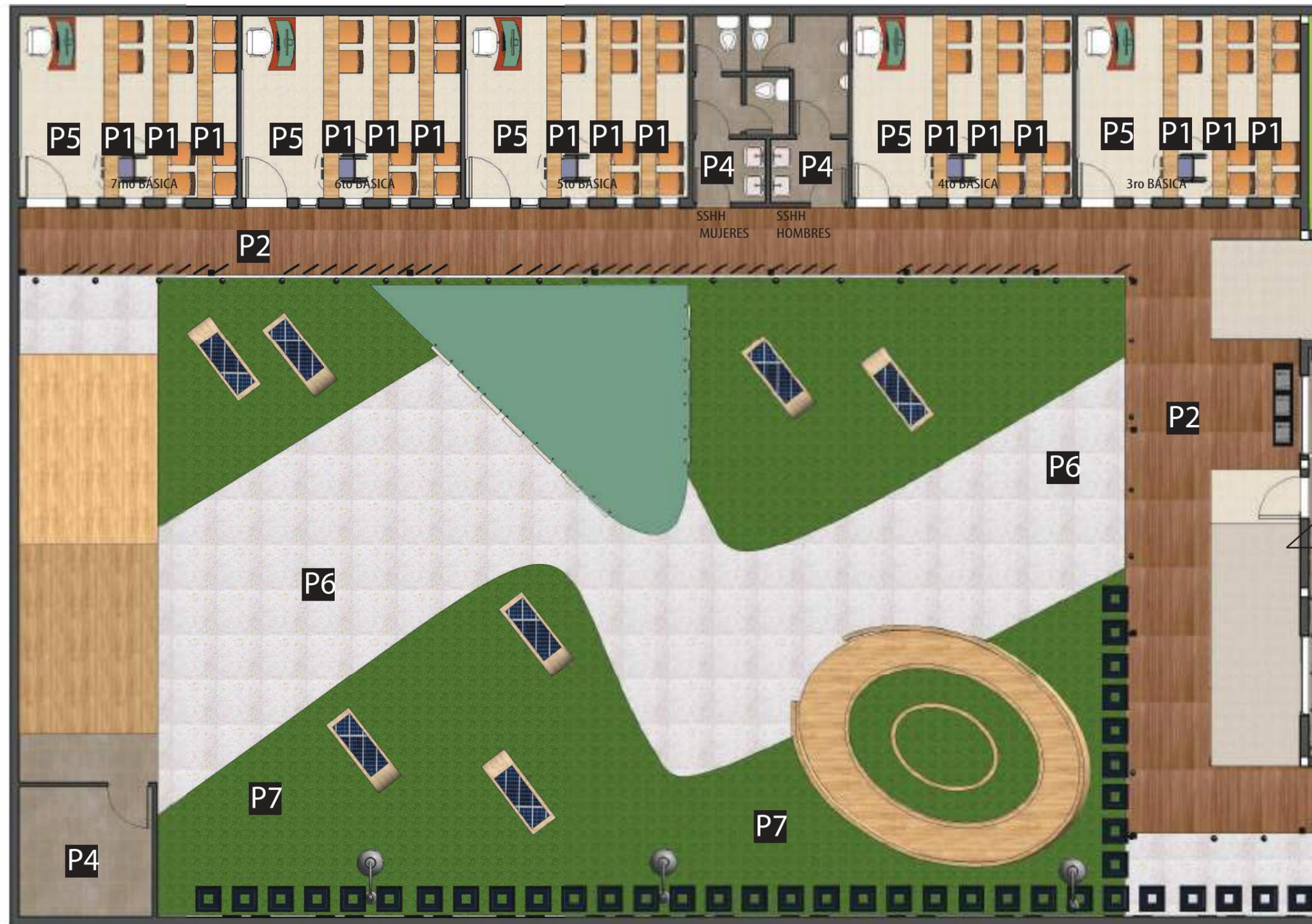
NOTA: EL P1 Y EL P5 SE ALTERNAN EN LAS AULAS DE 3RO A 7MO DE BÁSICA, CONJUNTAMENTE NIVELADOS PARA EVITAR ACCIDENTES.
