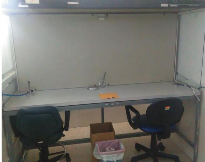
*Figura 18.* Cabina de flujo horizontal del Laboratorio de Cultivo de Tejidos del CIBE.
