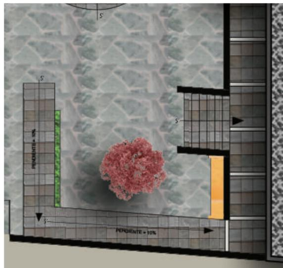
Rampas: Ancho mínimo: 1,20 m, cuando exista un giro de 90 grados se debe hacer en un plano horizontal.
