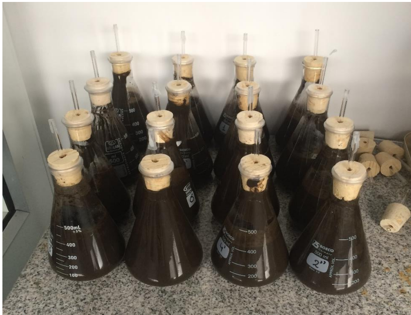
Anexo 4. Reactores (digestión anaerobia).
