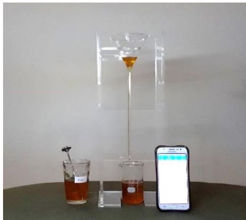
Figura 31. Toma de tiempo en viscosímetro para baja viscosidad con miel
