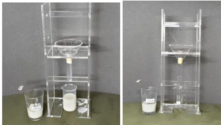
Figura 27. Toma de tiempo en viscosímetro para alta viscosidad con leche
