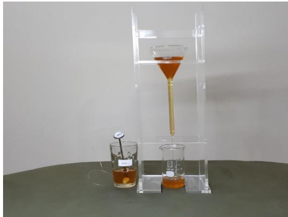
Figura 30. Toma de tiempo en viscosímetro para media viscosidad con miel
