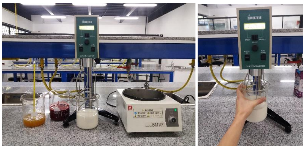
Figura 23. Medición de la viscosidad de leche descremada en viscosímetro de Brookfield.
