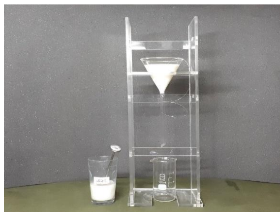
Figura 28. Toma de tiempo en viscosímetro para media viscosidad con leche
