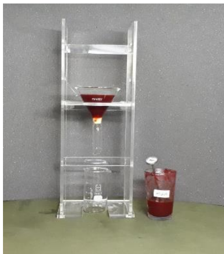
Figura 33. Toma de tiempo en viscosímetro para alta viscosidad con pulpa de mora
