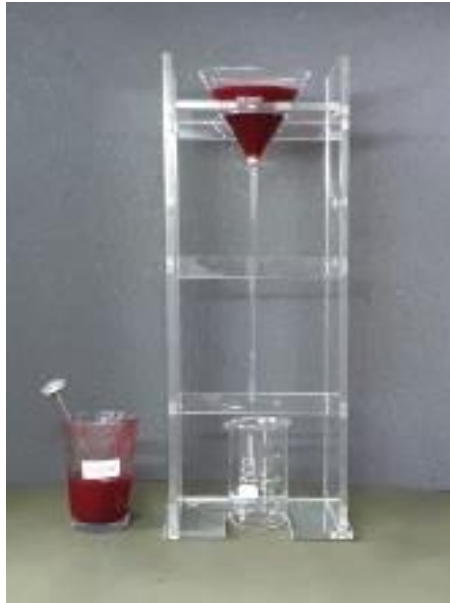
Figura 32. Toma de tiempo en viscosímetro para baja viscosidad con pulpa de mora
