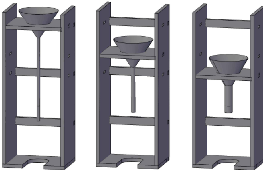
Figura 15. Diseño 3D del equipo de baja, media y alta viscosidad.
