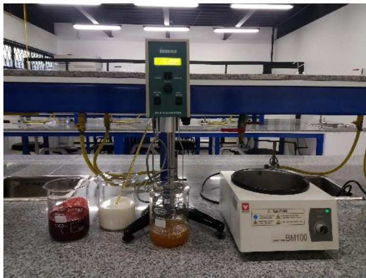
Figura 25. Medición de la viscosidad de miel en viscosímetro de Brookfield.
