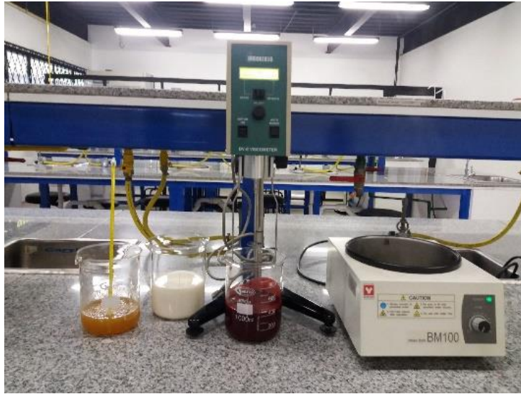
Figura 24. Medición de la viscosidad de pulpa de mora en viscosímetro de Brookfield.
