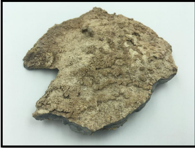
Figura 52. Muestra Formación Napo, Marga=Arena con carbonato de calcio, Arenisca Calcárea.
