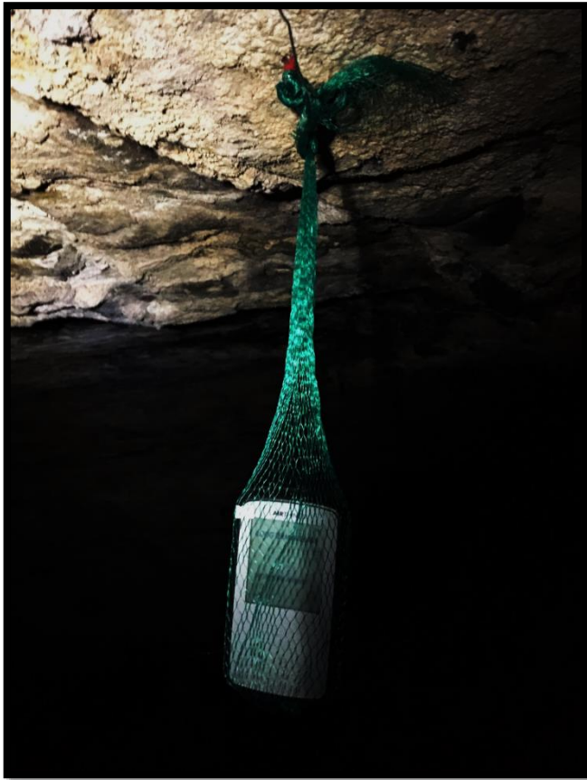
Figura 5. Red y ganchos para colocar los equipos de medición.
