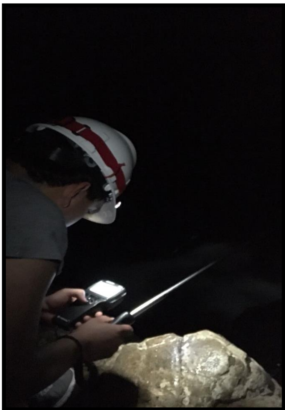
Figura 13. Medición de humedad relativa, temperatura y velocidad del viento utilizando el equipo Airflow modelo TA440.
