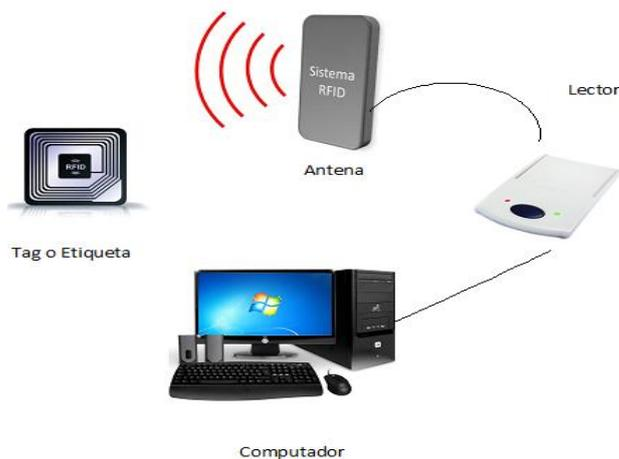
*Figura 3.* Componentes del Sistema RFID
