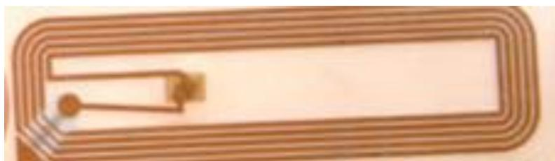
*Figura 9. Tarjetas RFID.*
