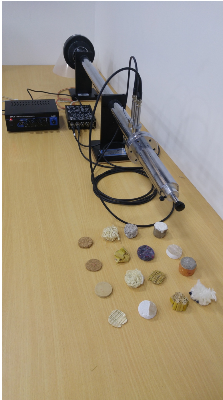
Figura 72. Conexión de tubo de Kundt con amplificador y DAQ. Muestras utilizadas para la investigación.
