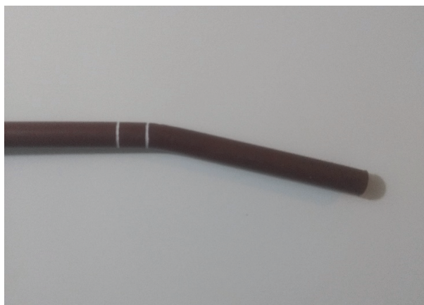
Figura 65: Curvatura de tubo para dar inclinación.
