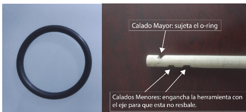
Figura 99: Herramienta para uniones de ejes horizontales con o-rings.
