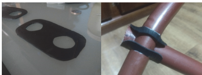
Figura 76: Unión horizontal de lámina de caucho.
