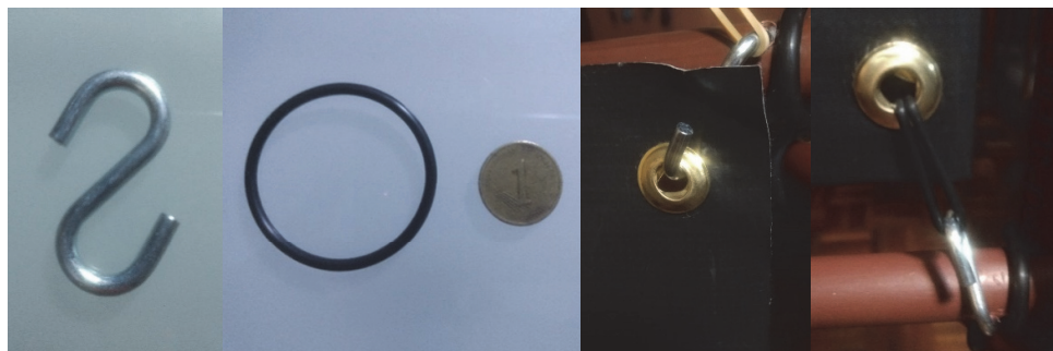
Figura 81: Tensión con O-rings y Gachos "S".
