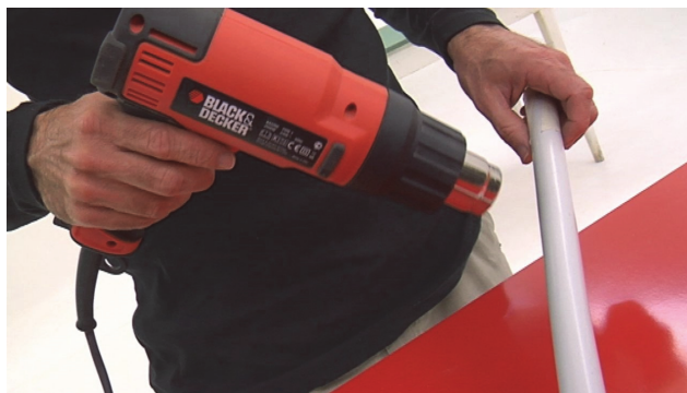
Figura 134: Aplicación de calor a tubo para doblado.
