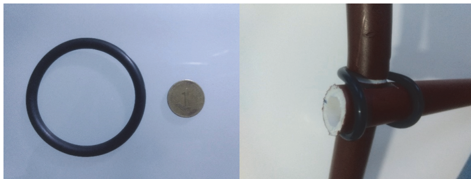
Figura 78: Unión horizontal con O-rings y calado eje vertical.
