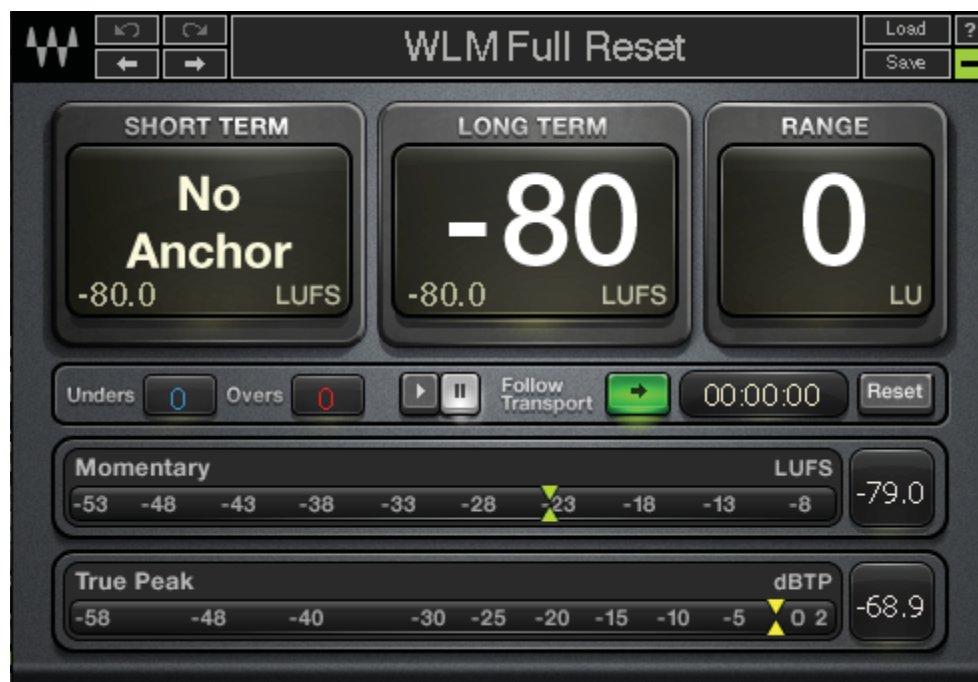
Figura 24. Screenshot de la configuración de WLM Meter.
