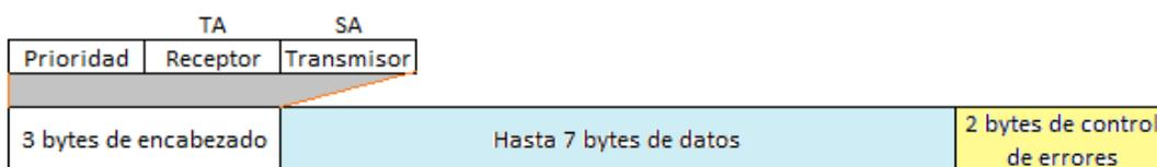
*Figura 10.* Estructura de la trama del mensaje.
