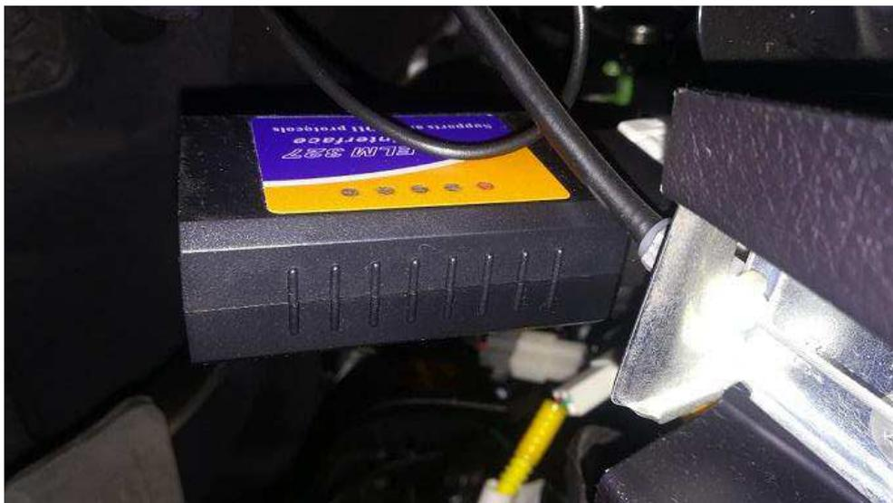
*Figura 36.* Conexión del dispositivo ELM327 en el puerto OBD II
