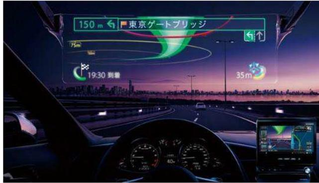
*Figura 1.* Ejemplo de sistema HUD. Proyección de pantalla PIONNER Nav Gate.
