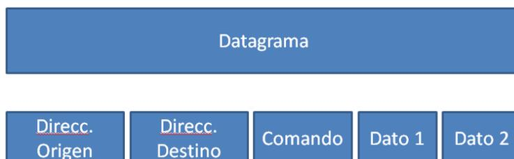
Figura 20. Estructura paquete de Datos BUSing
