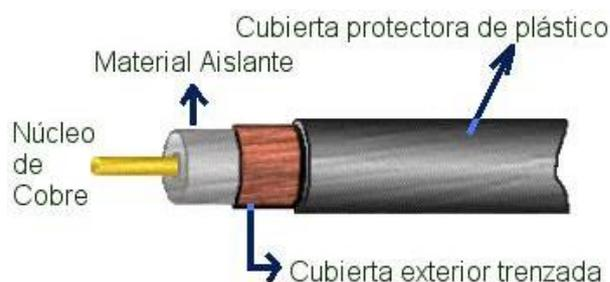
*Figura 6.* Estructura del Cable Coaxial.
