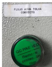
Figura 34. Luz Piloto “Flujo Agua Tolva Correcto”
