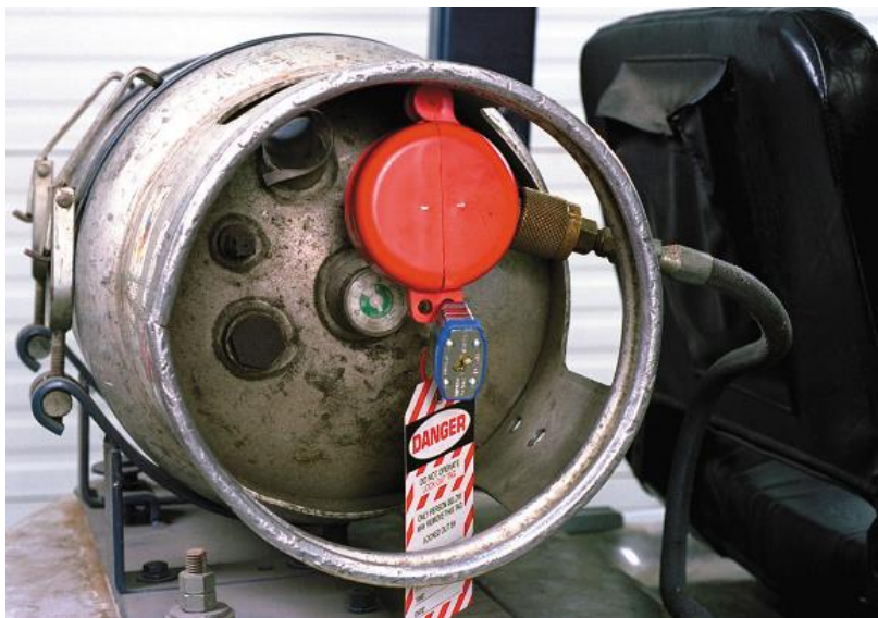
Figura 54. Poka Yoke Secuencial, Lockout Tagout en Montacargas Tomado de: Brady (2017)
