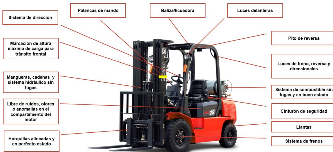
Figura 18. Aspectos básicos de seguridad para Montacargas Tomado de: (Cervecería Nacional CN S.A, 2017)
