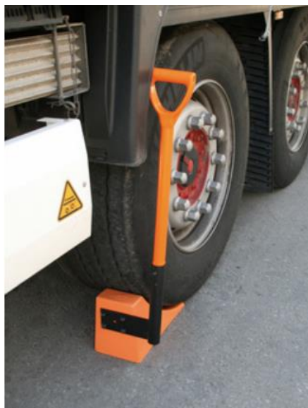
Figura 47. Cuña para camiones, tipo ergonómico
