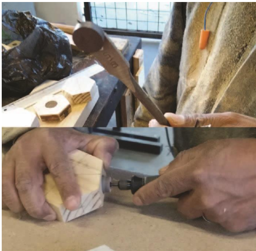
Figura 103. Utilización de broca para realización de agujeros.
