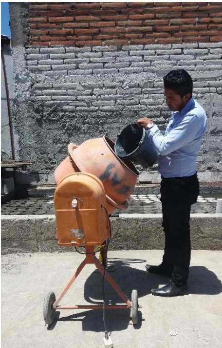
Figura 14. Adición de los componentes a la mezcladora mecánica.
