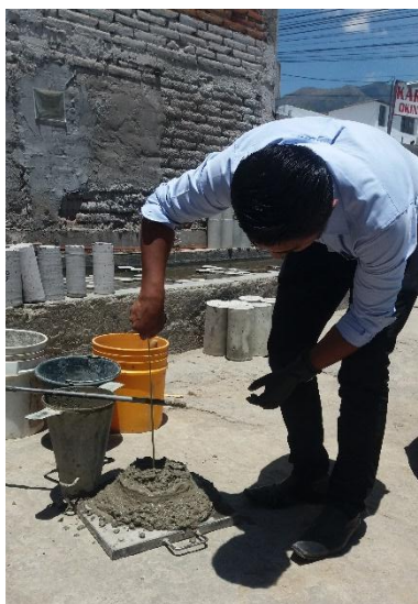
Figura 19. Ensayo de asentamiento mezcla definitiva
