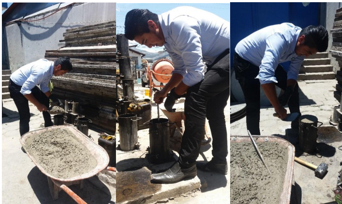
Figura 16. Elaboración de especímenes
