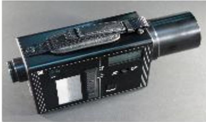
Figura 17 Luxómetro (instrumento de medición de iluminancia).
