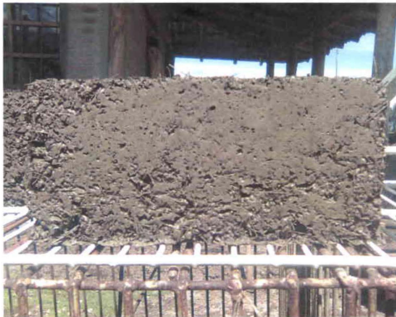
FIGURA 27. Submodelo A4, después del desmontaje del molde.
