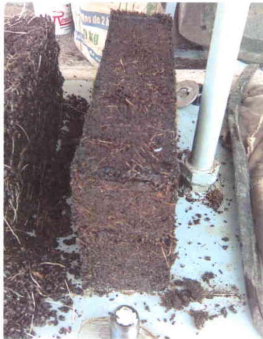
FIGURA 31(b). Submodelo B2, después del desmontaje del molde.
