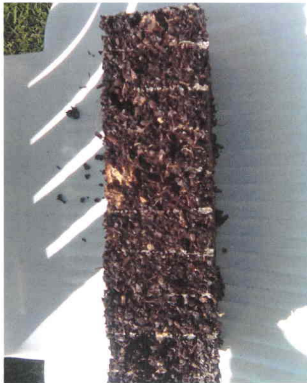
FIGURA 44. Formación de hongos y desprendimiento de partículas en el modelo D, Submodelo D2.
