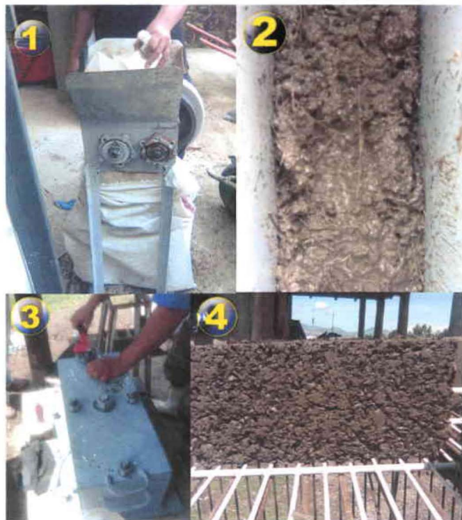
FIGURA 19. (1) Molienda, (2) Moldeado, (3) Prensado, (4) Secado.
