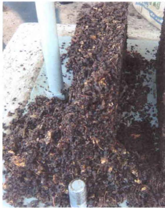
FIGURA 25. Submodelo A3, después del desmontaje del molde.
