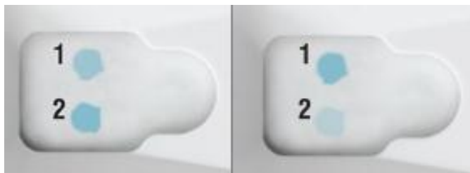
Figura 2. Prueba SNAP para detectar residuos de antibióticos. Adaptado de IDEXX, 2017.
