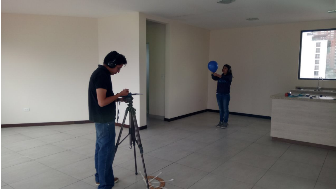
Figura 13. Proceso de medición de tiempo de reverberación en la sala Aranjuez.
