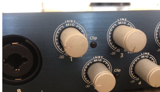
Figura 19. Perillas de ganancia 1 y 2 para la grabación de canales L y R del dummy head .
