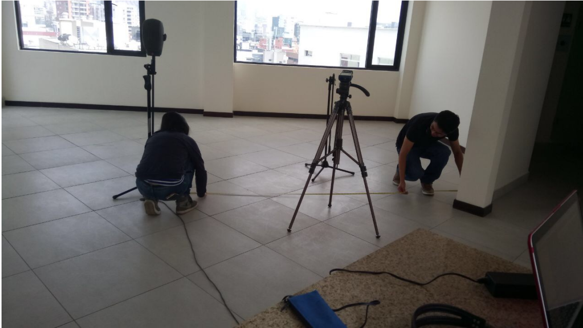
Figura 16. Identificación de puntos para la generación de impulsos en la sala Aranjuez.
