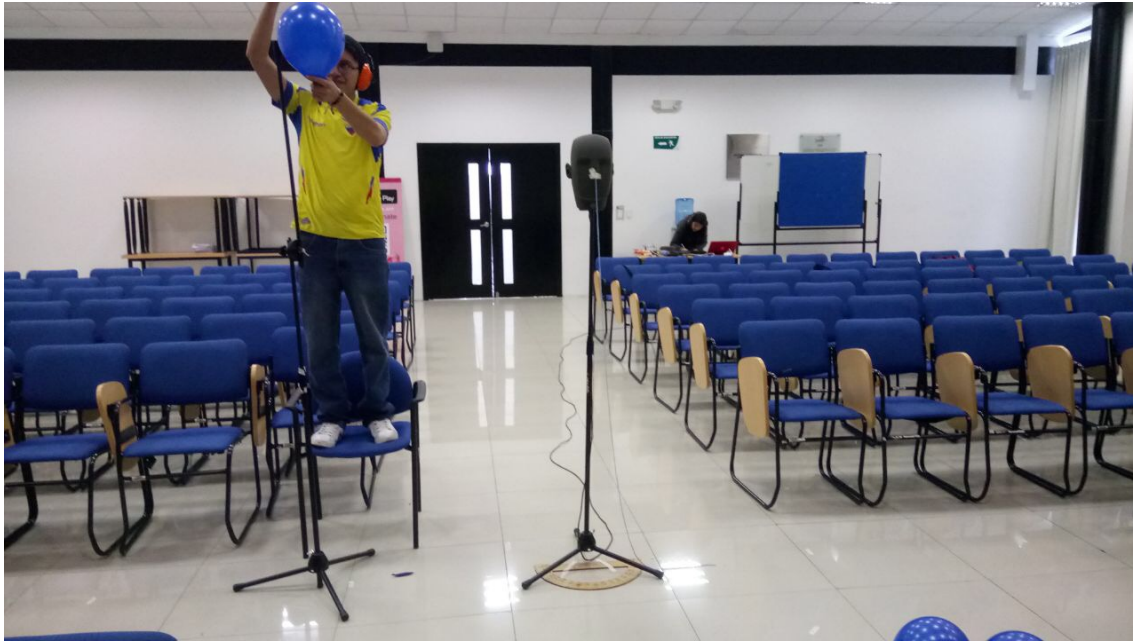
Figura 18. Generación de impulsos mediante la explosión de globos, en la sala Queri.
