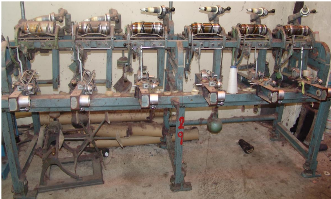
Fotografía 4. Ovinadora Lamb, para ovinar conos de hilo.
