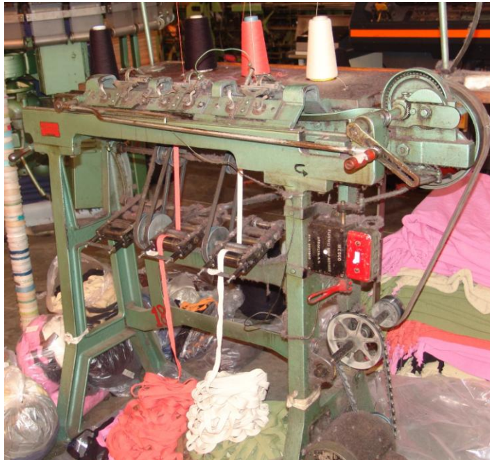
Fotografía 4. Ovinadora Lamb, para ovinar conos de hilo.
