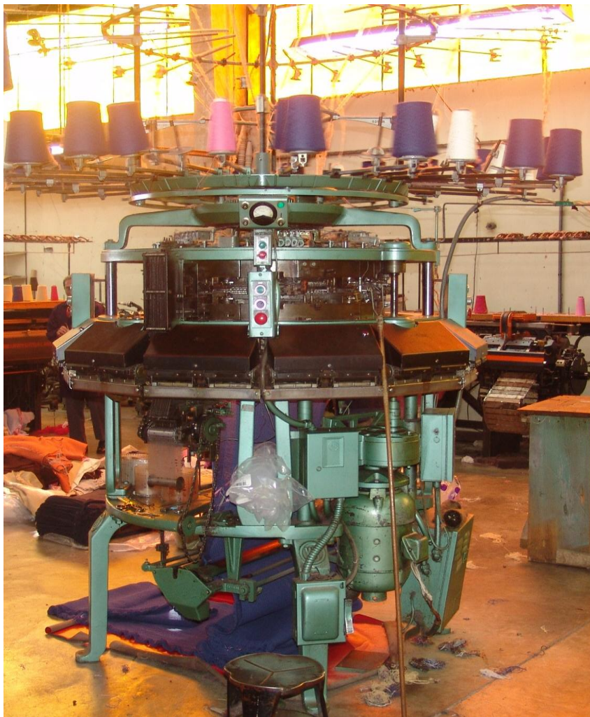
Fotografía 2. Máquina circular Wilmer Jacka Galga 8.
