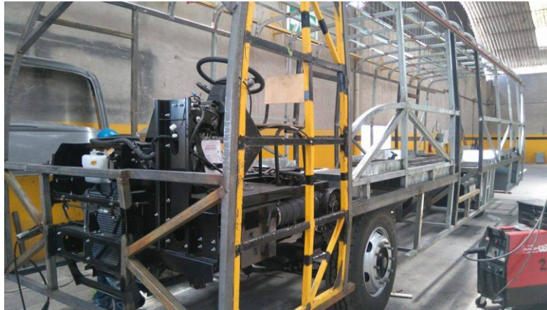
Figura 12. Estructura de seguridad del Chofer
