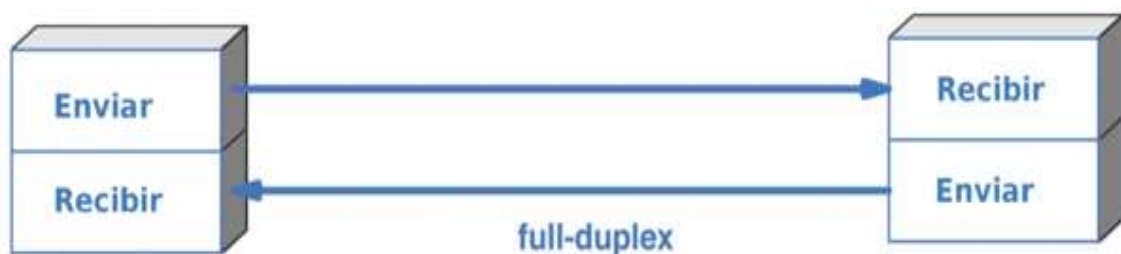
Figura 21. Conexión de enlace punto a punto full dúplex Tomado de Ubiquiti Network, 2017 .
