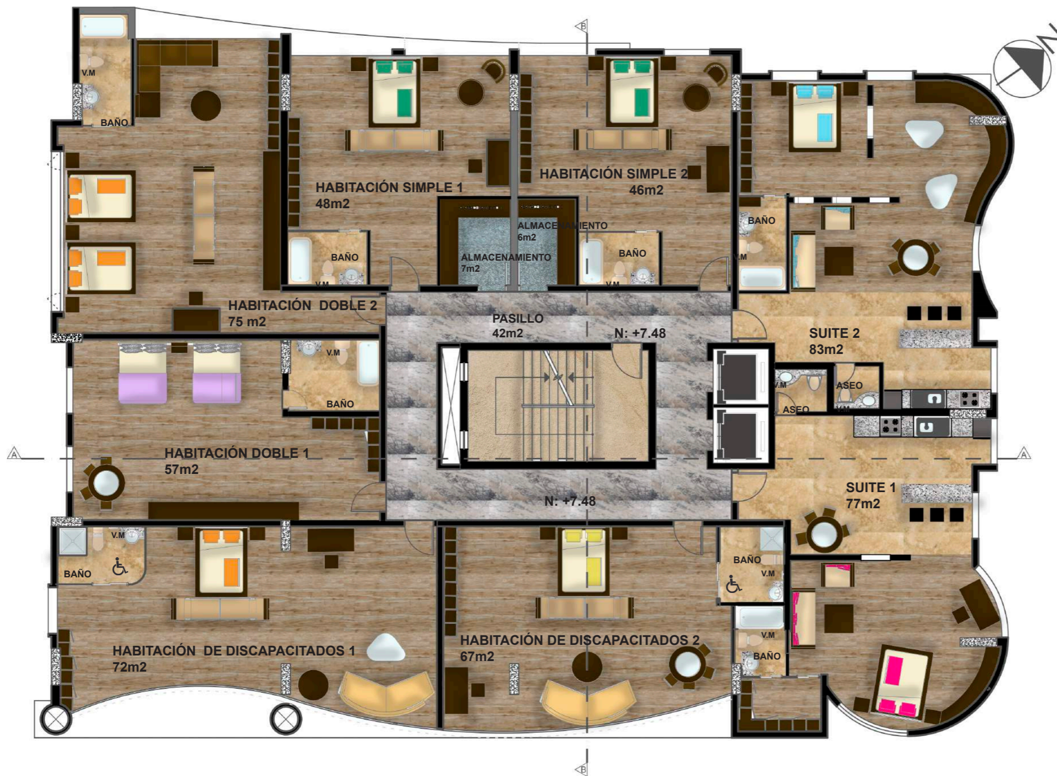
PLANTA INTERIORISTA-----PISO 3 TIPO N+7.48 ESCALA 1:125
