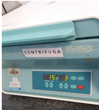
Figura 8. Se centrifugó la mezcla a 15000 rpm durante 3 minutos.
