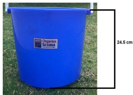
Figura 6. Dimensiones de altura contenedor para la determinación de la densidad suelta de residuos sólidos.
