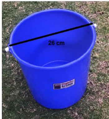
Figura 7. Dimensiones del diámetro del contenedor para la determinación de la densidad suelta de residuos sólidos.
