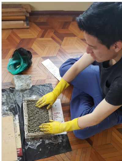
Figura 20. Proceso de moldeado del panel bagazo-barro de 25mm en el marco
