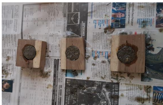
Figura 21. Proceso de moldeado de las muestras correspondientes a bagazo - barro de 25mm, 6mm y 12mm
