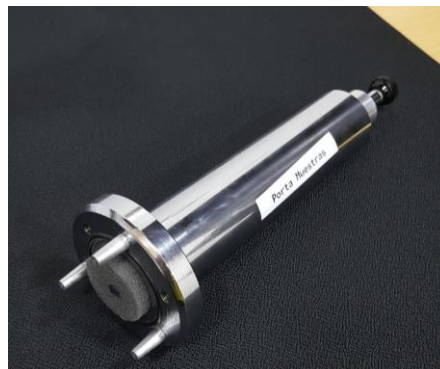
Figura 30. Inserción de la muestra estándar de 25 mm de espuma, en el porta muestras
