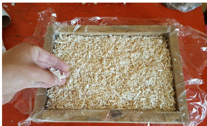
Figura 19. Llenado de fibra de bagazo en el molde
