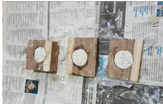
Figura 22. Proceso de moldeado de las muestras correspondientes a bagazo - yeso de 25 mm, 12 mm y 6 mm
