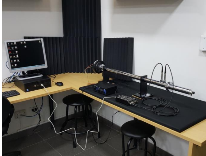
Figura 25. Cadena electroacústica del tubo de impedancia Kundt ubicado en el laboratorio de mediciones acústicas de la UDLA
