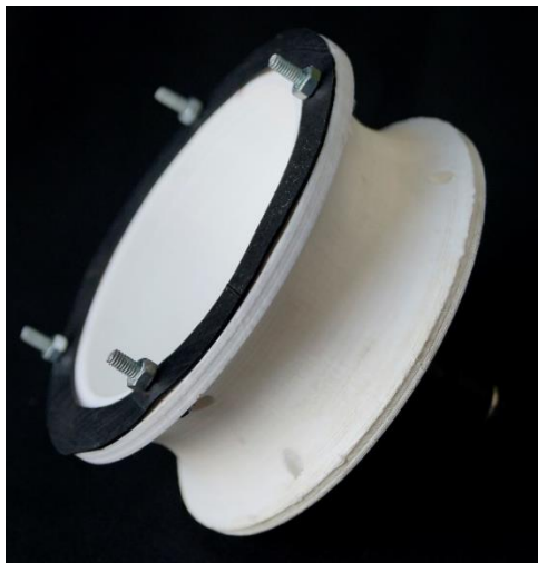
Figura 36. Difusor de aire impreso con lámina de caucho. Cámara del difusor con tornillos. Vista lateral.
