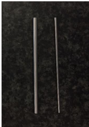
Figura 6. Patrones de alambre. Cumple la función de medir el radio de los orificios en las placas.
