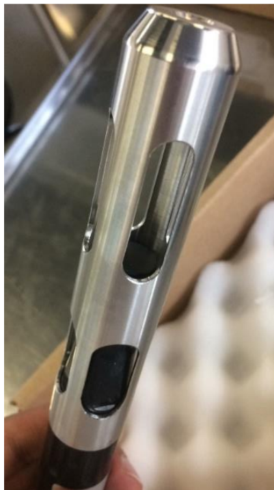
Figura 25. Sensor óptico. Parte de la sonda, que mide la concentración de oxígeno disuelto en agua por el método luminiscente, ya que no presenta electrodos ni soluciones.
