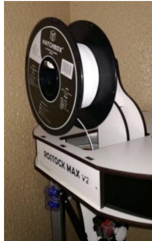
Figura 14. Filamento PLA. Materia prima para la impresión.
