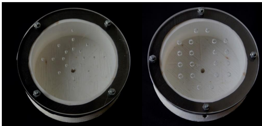
Figura 37. Difusor de aire impreso. Placas 1 y 2 con lámina de caucho ajustadas con tornillos y tuercas a la cámara del difusor. Vista superior
