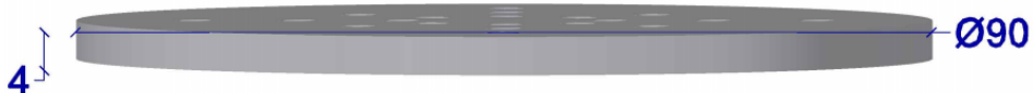
Figura 8. Acotamiento y modelado de la placa. Vista lateral. Representación de dimensiones en milímetros. Primer modelado en AutoCAD de la placa.
