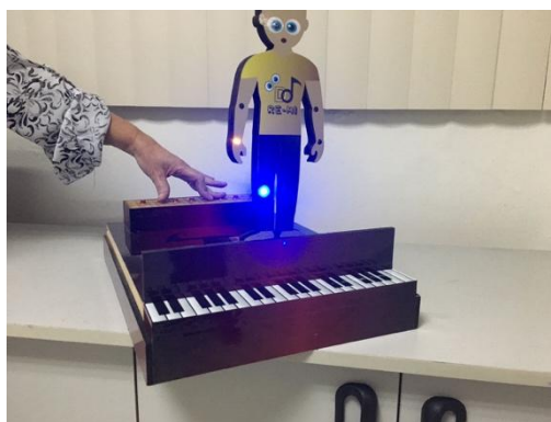
Figura 31. Luces encendidas del juego al presionar los pulsadores.
