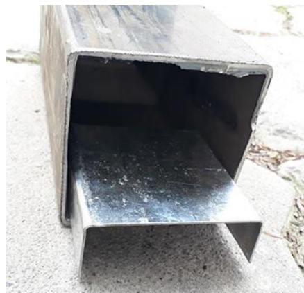
Figura 151. Ingreso de leña e ingreso de aire.
