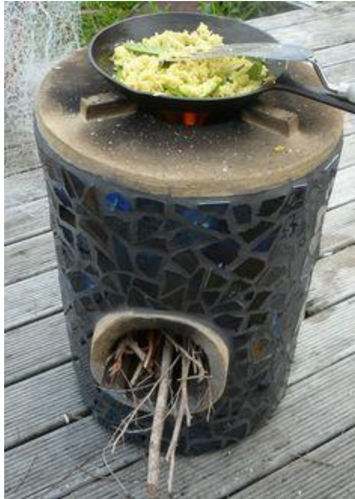
Figura 14. Estufa Rocket de forma cilíndrica, escape superior, construida con barro y pedazos de vidrio, uso exterior.
