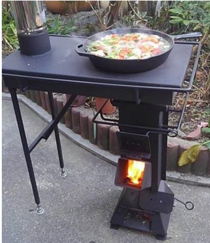
Figura 11. Estufa Rocket metálica con plancha superior y alimentador inclinado, uso exterior.
