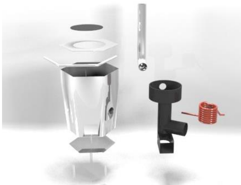
Figura 94. Representación de la propuesta Hexagonal, explosión de componentes
