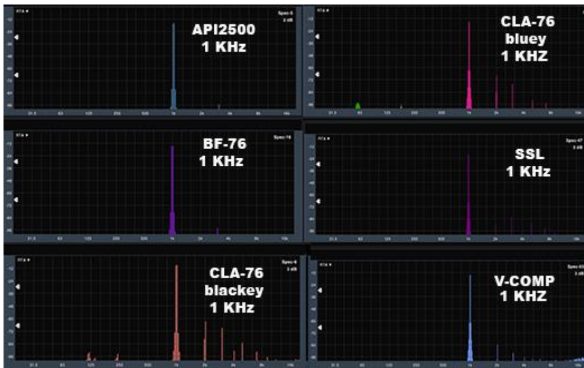
Figura 31. Análisis a tiempo real a 1/48 por octava, de un tono de 1 KHz, procesado con diferentes compresores.
