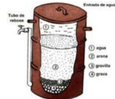
Figura 10. Filtro para purificación de agua potable Tomado de (Alianza Nacional Ríos y Cuencas de Costa Rica, 2016)
