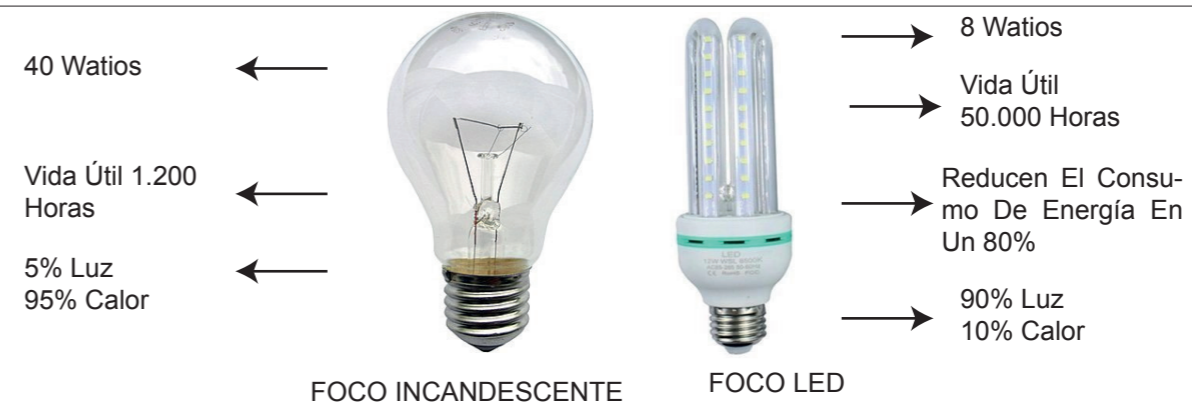
Figura 286. Foco incandescente y foco LED Adaptado de ( Kosiluz, s.f.)
