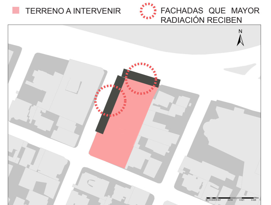
Figura 161. Fachadas que mayor radiación reciben.
